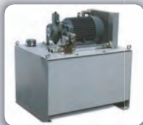
Unidad hidráulica para el movimiento longitudinal de la mesa.
