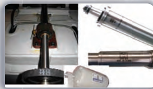
Husillo, motor CA para el movimiento transversal con tornillo a bolas recirculantes.
