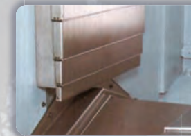
Protectores metálicos telescópicos para ejes Z e Y.
