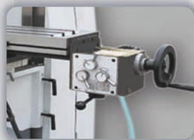
Avance automático a engranajes para el eje X.(para ZX7550ZW)
