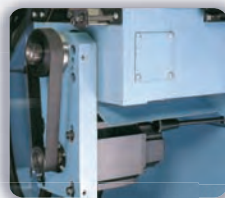
Sistema de movimiento de carro a través de correas.
