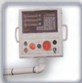
Panel de control con equipo de lectura digital para el modelo 4VS.
