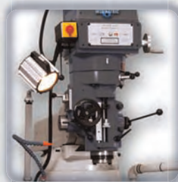
Husillo ISO 40 con pinola de 105 mm. y motor de 5 HP con variador de velocidad y avances automáticos para modelo 4VS.
