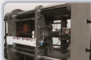
Estructura rígida y Columnas de cromo duro.
